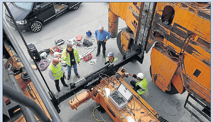
En af CMP's straddle carriers retrofittes til det nye Lasstec-system.
