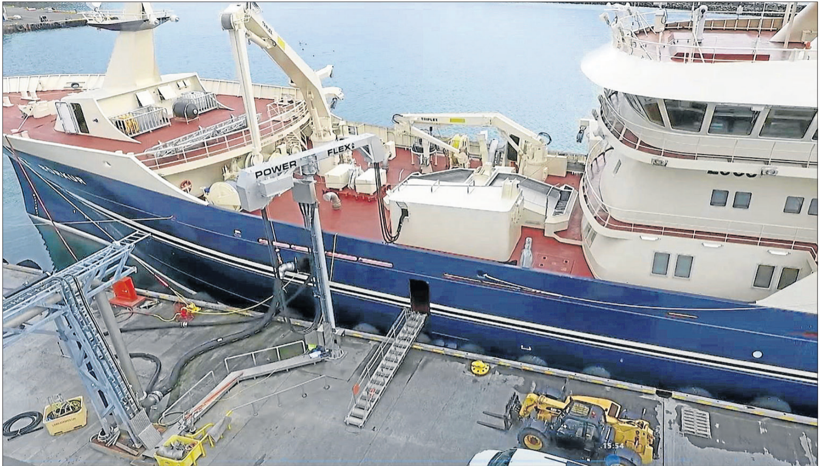
En stor pelagisk trawler ved kaj i Neskaupstadur på landstrøm via Power Flex' nye svingkran. Foto: Power Flex
